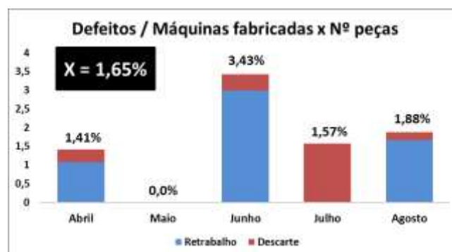
Figura 6 - Gráfico representativo do Retrabalho e Descarte da Usinagem
