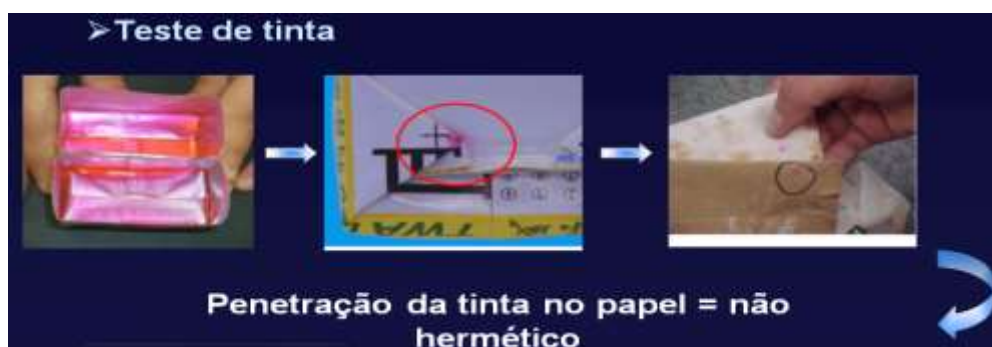
Figura 9 – Sequência do teste com tinta
