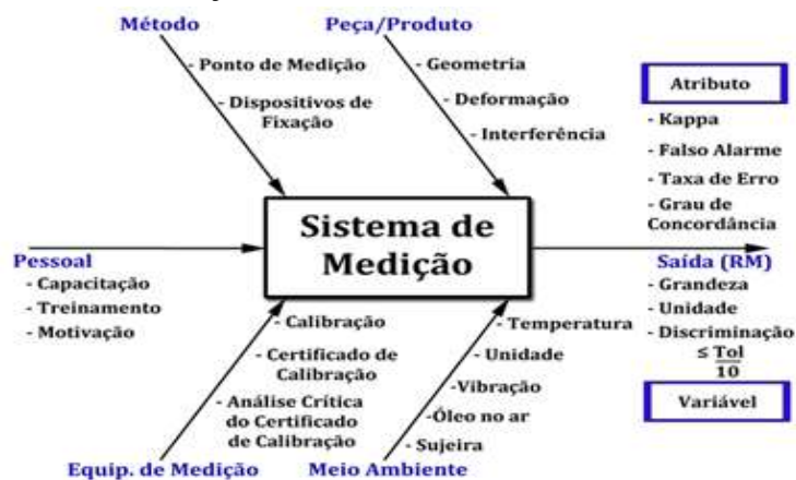
Figura 3: Diagrama do Sistema de Medição
