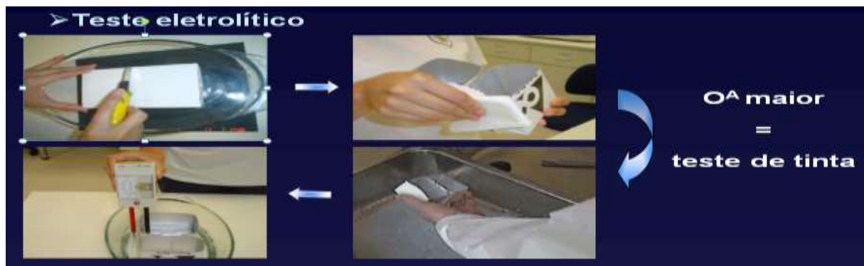
Figura 8 – Sequência do teste eletrolítico
