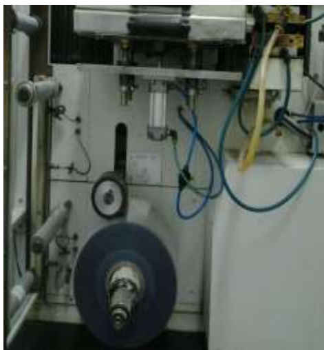
Figura 2: Sistema de alimentação de alumínio e PVC.
