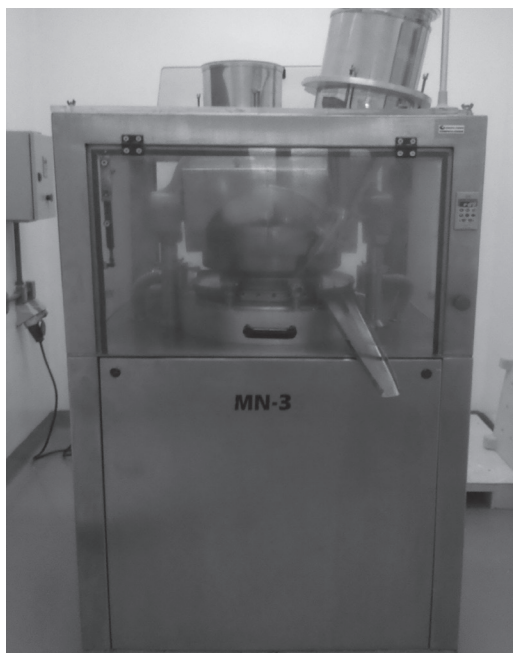
Figura 2 – Máquina Compressora Neuberger após processo de retrofitting Fonte: Os autores.
