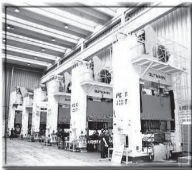
Linha de carroceria P2C - 4P - 400 ton. Mesa de trabalho 3000 x 1800 mm. Com mesa fixa ou móvel
